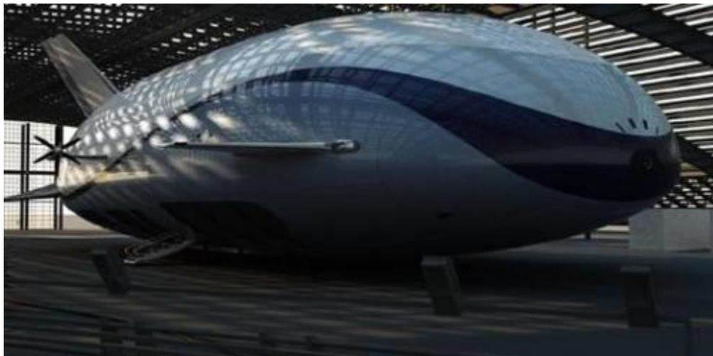
Канадская компания Skyhook совместно с Boeing объявила о проекте JHL-40 - грузового дирижабля с полезной нагрузкой 40 т. Это тоже «гибрид», однако здесь архимедова сила будет дополняться тягой четырех роторов, создающих тягу по вертикальной оси.
